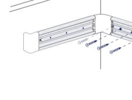
Marcar la posición de cada agujero en el muro y pre-perforarlo para fijar la posición de los brackets.
